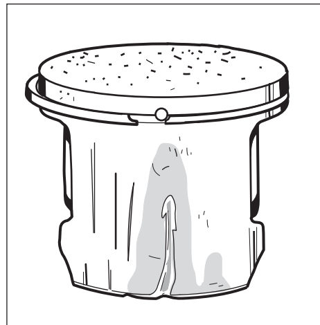
Oregelbundna räfflor på kolvens insugssida orsakade av brusten rullhållare.
