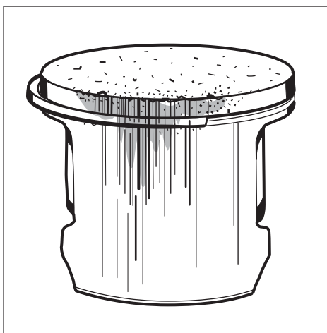
Avgassidan skadad av brusten kolring. Kolringsdelarna skadar kolvens överdel och förorsakar repmärken.
