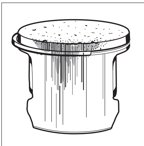
Avgassidan skadad av brusten kolvringskante. Kolvringsdelarna skadar kolvens överdel och förorsakar repmärken.
