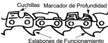
5. Coloque la cadena por encima y detrás del retén del embrague, encajando los eslabones impulsores en la rueda dentada del tambor de embrague.
