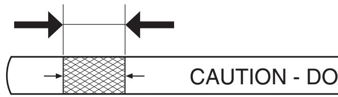
(RU) Уровень масла должен находиться между двумя метками на масломерном шупе. При необходимости долейте масло до верха штрихованной метки на щупе. Примерное количество и тип масла см. в разделе "СПЕЦИФИКАЦИЯ ПРОДУКТА" данного руководства. Не следует заливать жидкость в количестве, превышающем норму.
