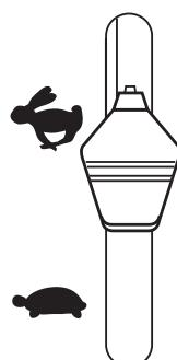
**RU** Разогретый двигатель: переместите регулятор газа на пол-пути в положение полного газа “充满了气”.
