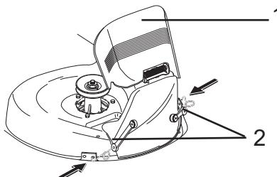
**(RU) Установка мульчирующей пластины (если имеется)**
