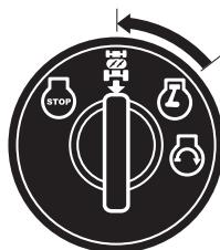
Положение двигателя "ON" (обычная работа)
