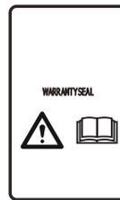
El chasis tiene componentes que son sensibles a las Descargas Electroestáticas (ESD, por sus siglas en inglés). Además, el chasis se debe volver a sellar de manera profesional. Por dichas razones, el chasis solo debe ser abierto por técnicos de mantenimiento autorizados. Un sello roto puede anular la garantía en su totalidad o de forma parcial.
