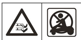
Se in funzione, non avvicinare mai le mani o i piedi al corpo del rasaerba robotizzato o al di sotto di esso. Non sedersi sul rasaerba robotizzato.
