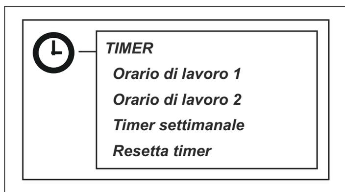
Il prato non dovrebbe essere tagliato troppo spesso per ottenere il miglior risultato di falciatura. Di conseguenza, è importante limitare il tempo di funzionamento con la funzione timer se l'area di lavoro è inferiore alla capacità di lavoro del rasaerba robotizzato. Se il rasaerba effettua un taglio eccessivo, il prato può risultare appiattito. Inoltre, il rasaerba robotizzato è soggetto a usura non necessaria.
