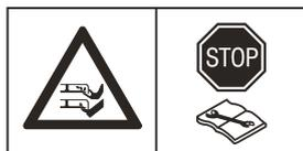
Il rasaerba robotizzato si avvia solo quando l'interruttore principale è in posizione 1 ed è stato immesso il codice PIN corretto. Portare l'interruttore principale in posizione 0 prima di eseguire ispezioni e/o interventi di manutenzione.
