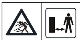
Manténgase a una distancia segura del robot cortacésped durante su funcionamiento. Mantenga alejados las manos y los pies de las cuchillas giratorias.
