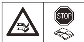
El robot cortacésped solo puede arrancar cuando el interruptor principal está en la posición 1 y se ha introducido el código PIN correcto. Seleccione la posición 0 del interruptor principal antes de llevar a cabo cualquier trabajo de inspección o mantenimiento.
