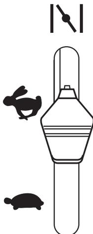
**(RU) Холодный двигатель:** приведите регулятор газа в крайнее положение choke (I\).
