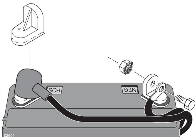
**RU** ⚠ **ПРЕДУПРЕЖДЕНИЕ:** Для того, чтобы предупредить образование искр в результате случайного заземления, необходимо вначале подсоединить положительный полюс.
