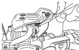
Neki prigušivači opremljeni su specijalnom mrežicom za sprečavanje iskri. Ako vaš stroj ima takvu vrstu prigušivača, potrebno je čistiti mrežicu. To možete učiniti sa čeličnom četkom.
