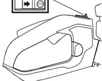
Запустите двигатель и проверьте, чтобы он остановился при переводе выключателя в положение стоп. Контакт остановки автоматически возвращается в положение запуска. Во избежание непроизвольного запуска, колпачок зажигания следует всегда снимать со свечи зажигания при монтаже, проверке и/или обслуживании.
