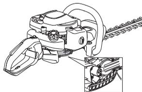
**VAROVÁNÍ!** Převod nelze zcela naplnit mazivem. Mazivo expanduje teplem, které vyvíjí stroj za chodu. Kdyby byl převod mazivem zcela naplněn, mohlo by dojít ke zničení těsnění a úniku maziva.
