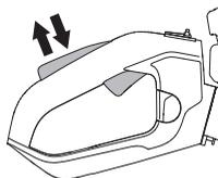
Verificați că butonul de accelerație și clichetul de blocare a accelerației se mișcă liber, iar arcurile de revenire funcționează.
