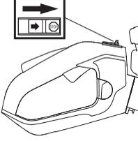
Motoru çalıştırınız ve stop düğmesi stop durumuna getirildiğinde motorun durduğunu denetleyiniz. Durdurma anahtarı otomatik olarak çalıştırma konumuna döner. Motorun istenmeden çalışmasını önlemek için montaj sırasında, motoru kontrol ederken ve/veya bakım yaparken buji kapaklarının çıkarılması gerekir.
