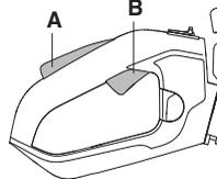
Zkontrolujte, zda při uvolnění pojistiky páčky plynu zapadne páčka plynu do polohy, při které je motor ve volnoběžných otáčkách.
