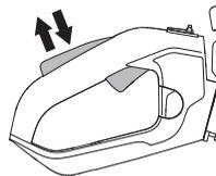
Zkontrolujte, zda se páčka plynu a její pojistka volně pohybují a zda jejich vratné pružiny fungují správně.
