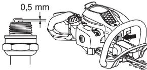
**UPOZORNENIE!** Vždy používajte odporúčaný typ zapaľovacej sviečky! Nesprávna zapaľovacia sviečka môže vážne poškodiť piest/valec. Skontrolujte, či je zapaľovacia sviečka správne nasadená.
