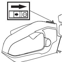
Naštartujte motor a presvedčte sa, či sa motor zastaví, keď pohnete vypínačom do polohy stop. Vypínač sa automaticky vráti do polohy štartovania. Kryt zapalovacej sviečky treba pri montáži, kontrole a údržbe odmontovať zo sviečky, aby sa zabránilo náhodnému naštartovaniu.
