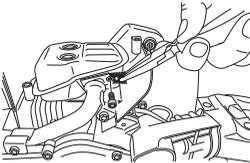
Bazı susturucular özel bir kıvılcım önleyici ızgara ile donatılmıştır. Makinenizde bu tip bir susturucu varsa, ağı temizlenebilir. Bu işlem, en iyi tel fırça ile yapılır.
