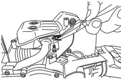
Unele amortizoare de zgomot sunt dotate cu o plasă specială anti-scântei. Dacă dispozitivul este echipat cu un amortizor de zgomot de acest tip, plasa trebuie curățată. Această operație se efectuează cel mai bine cu o perie de sârmă.
