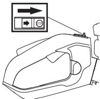
Włącz silnik i sprawdź, czy po przesunięciu wyłącznika w położenie stop silnik zatrzyma się. Wyłącznik powraca samoczynnie w położenie "start". Dlatego przed przystąpieniem do montażu, kontroli oraz/lub konserwacji należy zawsze zdejmować nasadkę ze świecy zapłonowej w celu zapobieżenia niezamierzonemu uruchomieniu silnika.
