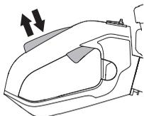
Проверьте, чтобы ручка газа и блокировочный рычаг перемещались свободно и чтобы возвратные пружины работали соответствующим образом.
