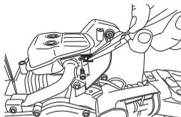
Neki prigušivači su opremljeni specijalnom mrežicom protiv iskričenja. Ako vaša mašina ima tu vrstu prigušivača, mrežicu je potrebno čistiti. To je najbolje napraviti žičanom četkom.
