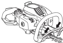
Sprawdź regularnie, czy elementy amortyzujące nie są pęknięte lub czy nie uległy deformacji. Sprawdź, czy elementy amortyzujące są całe i dobrze zamocowane.
