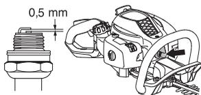
**ВНИМАНИЕ!** Всегда используйте только указанный тип свечи! Применение несоответствующей модели может привести к серьезным повреждениям поршня/цилиндра. Следите за тем, чтобы свеча была оснащена т.н. изоляцией радиопомех.
