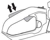
Proveri da li se regulator gasa i kočnica regulatora gasa slobodno pokreću i da li ispravno rade povratne opruge.
