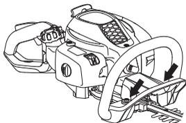
Ellenőrizze rendszeresen a rezgéscsillapító elemeket, repedések és torzulások szempontjából. Ellenőrizze, hogy a rezgéscsökkentő egységek sértetlenek-e és rögzítve vannak-e.
