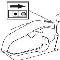
Upalite motor i provjerite da li se motor zaustavlja kada pritisnete glavni prekidač u stop položaj. Zaustavni prekidač automatski se vraća u položaj uključenosti. Kako biste spriječili slučajno pokretanje, morate ukloniti kapicu sa svjećice prilikom sklapanja, provjere i/ili održavanja motora.
