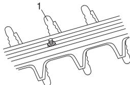
Provjerite da zaštita sječiva nije oštećena ili iskrivljena. Zamijenite rezni nastavak ako je savijen ili oštećen.
