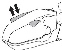
Убедете се, че пусковият механизъм и фиксаторът на дроселната клапа се движат свободно и възвратните пружини са в изправност.
