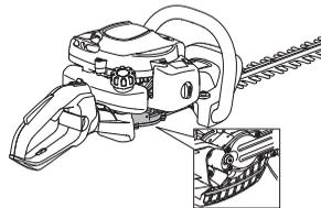
**UPOZORNENIE!** Skriňa prevodovky nesmie byť úplne naplnená mazivom. Pri zahrievaní stroja počas prevádzky sa objem maziva zväčšuje. Ak by bola skriňa prevodovky úplne naplnená mazivom, mohlo by dôjsť k poškodeniu tesnenia a presakovaniu maziva.
