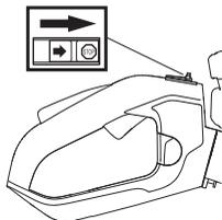
Upali motor i kontroliši da li se motor ugasi kad se prekidač premjesti u stop-položaj. Stop prekidač se automatski vraća na start poziciju. Da bi se spriječilo nenamjerno paljenje, poklopac ručice za paljenje mora biti skinut sa ručice za paljenje tokom montiranja, provjeravanja i/ili servisiranja.
