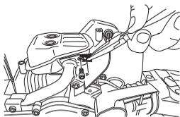
Některé tlumiče výfuku jsou vybaveny speciálním sítkovým lapačem jisker. Pokud je váš stroj vybaven takovým typem tlumiče výfuku, sítko je potřeba čistit. Sítko čistíte drátěným kartáčem.
