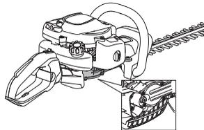
**UWAGA!** Przekładni nie należy napełniać smarem całkowicie. Smar ulega rozszerzalności pod wpływem ciepła powstającego podczas pracy maszyny. W przypadku całkowitego napełnienia smarem istnieje ryzyko uszkodzenia uszczelek i powstania wycieków smaru.
