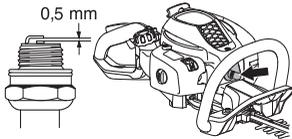
**ATENȚIE!** Folosiți întotdeauna bujii de tipul recomandat! O bujie incorectă poate să distrugă pistonul și cilindrul. Aveți grijă ca bujia să aibe așa numită protecție la unde radio.
