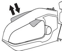
Skontrolujte, či sa páčka plynu a poistná páčka plynu voľne pohybujú a či vratné pružiny náležite fungujú.
