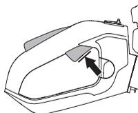
Pritisnite gumb za gas i provjerite da li se vratio u svoj prvobitni položaj nakon što ste ga otpustili.
