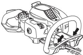
Verificați în mod regulat elementele de reducere a vibrațiilor în privința fisurilor și deformațiilor. Controlați ca elementele de reducere a vibrațiilor să fie întregi și strâns montate.
