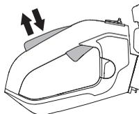
Provjerite da li se kontrola gasa i gumb gasa kreću neometano i da li povratne opruge rade ispravno.
