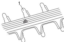
Štitnik oštrice ne smije biti oštećen ili iskrivljen. Zamijenite savijeni ili oštećeni rezni nastavak.
