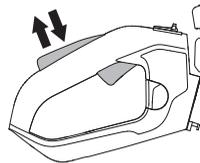
Kontroliši da li regulator gasa i regulator za ograničavanje gasa idu lako kao i da li funkcionišu njihovi sistemi povratnih opruga.
