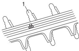
Проверете дали защитният капак на резците не е повреден или изкривен. Подменете режещия модул, ако бъде огънат или повреден.
