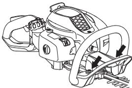
Redovno provjeravajte da li su se pojavile pukotine ili nepravilnosti na napravi za smanjivanje vibracija. Provjerite amortizere radi mogućih oštećenja ili iskrivljenja.
