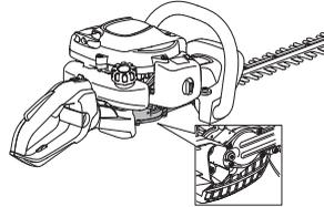
**DİKKAT!** Dişli kovani tamamen yağ ile doldurulmamalıdır. Çalışma sırasında makine ısındıkça yap genişler. Dişli kovani tamamen yağ ile doldurulursa contalar zarar görüp yağ sızıntısına neden olabilir.
