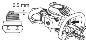
**UWAGA!** Stosuj wyłącznie świece zalecane przez producenta. Niewłaściwa świeca może być przyczyną zatarcia tłoka/cylindra. Dopilnuj, aby świeca zapłonowa była wyposażona w tzw. eliminator zakłóceń radiowych.
