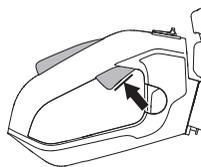
Wciśnij blokadę dźwigni gazu i sprawdź, czy po zwolnieniu nacisku powraca ona do położenia wyjściowego.
