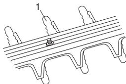
Proverite da štitnik za sečivo nije oštećen ili iskrivljen. Ukoliko je rezna jedinica iskrivljena ili oštećena, zamenite je.
