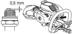
**NAPOMENA!** Uvek upotrebjavaj preporučeni tip svećice! Pogrešna svećica može da dovede do teškog oštećenja klipa/cilindra. Proveri da svećica ima tkz. zaštitu protiv radio valova.
