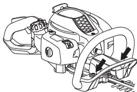
Redovno proveravaj da kod antivibracionih delova nema pukotina ili izobličenja. Prekontrolišite da li su elementi za zaštitu od vibracija celi i dobro učvršćeni.
