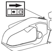
Nastartujte motor a zkontrolujte, zda se motor zastaví při přesunutí vypínače zapalování do vypnuté polohy. Vypínač se automaticky vrátí do výchozí polohy. Abyste se při montáži, kontrole a/nebo údržbě vyhnuli nezamýšlenému nastartování je nutno vždy odejmout rozbušku od zapalovací svíčky.
