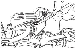
Niektóre typy tłumików są wyposażone w siatkę przeciwiskrową. Jeżeli w Twojej maszynie występuje taki typ tłumika, siatkę należy czyścić. Najlepiej jest to robić szczotką drucianą.
