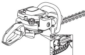
**ВНИМАНИЕ!** Корпусът на предавката не трябва да е пълен догоре със смазка. Смазката се разширява с увеличаването на температурата на машината по време на работа. Ако корпусът на предавката бъде напълнен догоре със смазка тя може да повреди уплътненията и да доведе до утечка на смазката.
