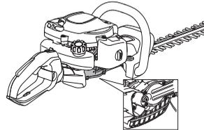
**ATENȚIE!** Carcasa angrenajului nu trebuie umplută complet cu unsoare. Unsoarea se dilată pe măsură ce aparatul se încălzește în timpul utilizării. Umplerea completă a carcasei angrenajului cu unsoare poate duce la deteriorarea garniturilor și la scurgeri de unsoare.
