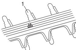
Sprawdź, czy osłona noży nie jest uszkodzona lub zdeformowana. Wymień zespół tnący, jeżeli jest wykrzywiony lub uszkodzony.
