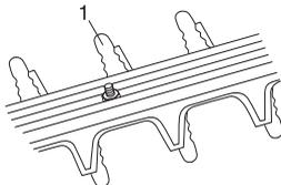
Verificați apărătoarea lamei: aceasta nu trebuie să fie deteriorată sau deformată. Înlocuiți dispozitivul de tăiere, dacă este îndoit sau deteriorat.
