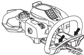
Kontroliši redovno antivibracione elemente da nema pukotina u materijalu i deformacija. Kontroliši da li je antivibracioni element čitav i čvrsto pričvršćen.
