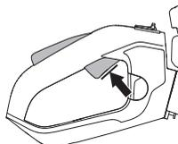
Pritisni kočnicu regulatora gasa i proverite da li se vraća u prvobitni položaj kad je otpustiš.
