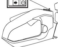
Включете двигателя и се убедете, че той се изключва, когато ключът е поставен в положение стоп. Изключвателят автоматично се връща на първоначалното си положение. За да предотвратите неумишлено запалване капачката на свещта трябва да бъде отстранена от свещта при монтиране, проверка и/или провеждане на техническа поддръжка.
