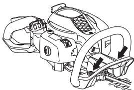
Pravidelně kontrolujte, zda se na blocích antivibračního systému neobjevují trhliny či deformace. Ujistěte se, že jsou tlumiče vibrací nepoškozené a řádně připevněné.
