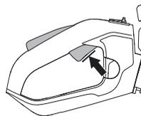
Stiskněte pojistku páčky plynu a zkontrolujte, zda se po uvolnění vrátí do své výchozí polohy.
