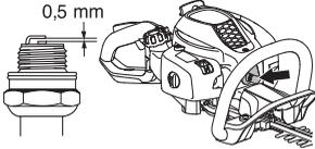
**ΠΡΟΣΟΧΗ!** Χρησιμοποιείτε πάντοτε τον τύπο μπουζιού που συστήνεται! Λάθος τύπος μπορεί να προκαλέσει ζημιά στο έμβολο/κύλινδρο. Ελέγξτε αν το μπουζι είναι εφοδιασμένο με συμπιεστή.
