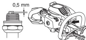
**VAROVÁNÍ!** Vždy používejte doporučený typ zapalovacích svíček! Použití jiného typu zapalovacích svíček by mohlo poškodit píst či válec. Dbejte na to, aby svíčka měla tzv. radiové odrušení.
