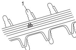
Zkontrolujte, zda kryt čepelí není poškozen nebo deformován. Ohnuté nebo poškozené žací ústrojí vyměňte.
