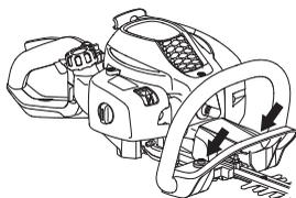
Redno preverjajte stanje elementov za dušenje vibracij. Bodite pozorni na morebitne razpoke in druge deformacije. Prepričajte se, če so dušilni elementi celi in dobro pritrjeni.
