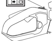
Ξεκινήστε τη μηχανή και βεβαιωθείτε ότι ο κινητήρας σταματάει μόλις φέρνετε το διακόπτη στη θέση στοπ. Ο διακόπτης στοπ επανέρχεται αυτόματα στη θέση εκκίνησης. Για να αποφύγετε ακούσια εκκίνηση του κινητήρα, πρέπει πάντοτε να βγάξετε το κάλυμμα του μπουζιού κατά τη συναρμολόγηση το έλεγχο ή/και τη συντήρηση.
