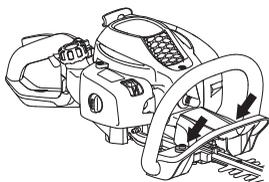
Pravidelne kontrolujte tlmiče vibrácií, či nie sú prasknuté alebo deformované. Skontrolujte, či nie je tlmič vibrácií poškodený a či je bezpečne pripojený.
