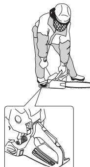
Povucite ručicu startera desnom rukom i polako vucite startno uže dok ne osetite otpor (dok se uhvate zapori startera), a zatim brzo i naglo povucite tako da se motor upali.
