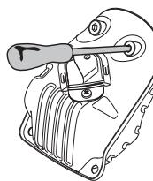
Neki prigušivači opremljeni su specijalnom mrežom. Ako tvoja mašina ima takav prigušivač treba mrežu čistiti bar jednom nedeljno, što se radi žičanom četkom. Blokirana mreža izazivaće pregrevanje mašine i može da dovede do ozbiljnih oštećenja.
