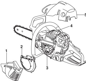
Rashladni uređaj čisti četkom jednom nedeljno, a po potrebi i češće. Prljav ili začepljen rashladni uređaj dovodi do pregrejanja mašine i oštećenja klipa i cilindra.
