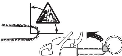
Lančana testera uvek odskače u ravni sečenja. Lančana testera i mač obično odskaču unatrag i nagore u pravcu rukovaoca. Ipak, lančana testera može da odskoči i u drugom
