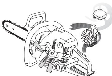
**VAŽNO!** Za trajno funkcionisanje centrifugalnog čišćenja potrebno su stalno održavanje i briga. Očisti ulaz vazduha u starter, elise zamajca, prostor oko zamajca, ulaznu cev i karburatorski prostor.
