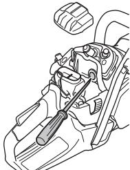
Za temperature ispod -5°C i/ili snežne uslove dostupna je posebna zaštita, koja se montira na kućište startera.
