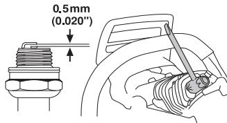
Beleška! Uvek upotrebjavaj preporučen tip svećice! Pogrešna svećica može da dovede do teškog oštećenja klipa/cilindra. Proveri da svećica ima tkz. zaštitu protiv radio valova.
