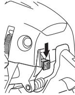
**ПОМНИТЕ!** Выключатель Запуск/Остановка автоматически переходит рабочее положение. В целях избежания непроизвольного запуска, головка свечи должна быть всегда снята со свечи при сборке, проверке и/или обслуживании.
