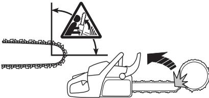
Отдача всегда происходит в плоскости резания пилы. Обычно при отдаче моторную пилу отбрасывает назад и вверх в направлении рабочего. Тем не менее моторная пила в момент отдачи может двигаться в различных направлениях в зависимости от метода резки,
