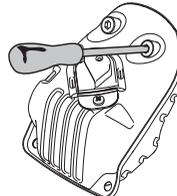
В некоторых глушителях предусмотрен специальный искрогаситель. Если ваша машина оборудована таким глушителем, сетку фильтра следует чистить раз в неделю. Наилучшие результаты достигаются с помощью стальной щетки. Забитая решетка приводит к работе с горячим двигателем, что дает серьезные повреждения двигателя.
