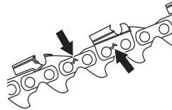
Для определения степени износа цепи мы рекомендуем проводить визуальное сравнение с новой цепью.
