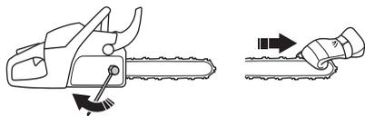
Расположение винта натяжения цепи может быть различным на различных моделях наших моторных пил. См. указания в разделе Что есть что? относительно того, где он расположен на Вашей модели пилы.
