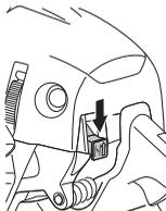
**ПОМНИТЕ!** Выключатель Запуск/Остановка автоматически переходит рабочее положение. В целях избежания непроизвольного запуска, головка свечи должна быть всегда снята со свечи когда вы оставляете машину без присмотра.
