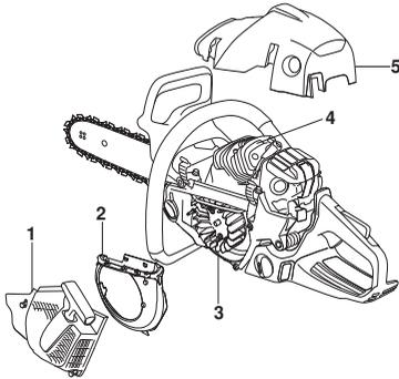
Производители очистку системы охлаждения щеткой раз в неделю или чаще, если этого требуют условия работы. Загрязненная или засоренная система охлаждения может привести к перегреву машины и вызвать повреждение поршня и цилиндра.
