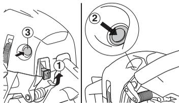
Afferrare saldamente l'impugnatura anteriore con la sinistra. Inserire il piede destro nella staffa posta nella sezione inferiore dell'impugnatura posteriore e premere la macchina contro il terreno.
