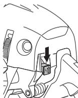
**NB!** Il contatto di avviamento/arresto torna automaticamente in posizione di marcia. Prevenire l'avviamento involontario rimuovendo sempre il cappuccio dalla candela quando si lascia la macchina incustodita.
