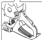
Tirare lentamente la fune di avviamento con la destra fino a quando fa resistenza (entra in presa il dispositivo di avviamento) e tirare quindi con strappi decisi e veloci finché il motore si avvia.
