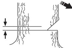
Inserire l'appoggio per la corteccia dietro il fulcro (se è stato montato l'apposito dispositivo). Lavorare a pieno gas e far avanzare la catena/lama lentamente nel tronco. Controllare che l'albero non si muova in direzione opposta a quella prevista per la caduta. Inserire un cuneo di abbattimento o un grimaldello non appena possibile.
