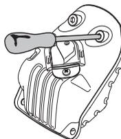
Alcune marmitte sono dotate di una speciale retina parascintille. Se la macchina è dotata di una marmitta di questo tipo, è consigliabile pulire la retina una volta alla settimana. Per un risultato ottimale usare una spazzola di acciaio. Una rete intasata comporta surriscaldamento del motore con conseguenti danni allo stesso.
