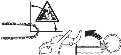
Il contraccolpo avviene sempre lungo il piano di taglio della lama. Di solito il movimento di motosega e lama è verso l'alto e verso l'operatore. Possono tuttavia verificarsi altre situazioni a seconda della posizione della
