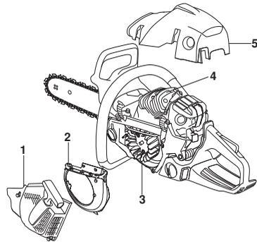
Pulire il sistema di raffreddamento con una spazzola una volta la settimana, più spesso se necessario. Se il sistema di raffreddamento è sporco o ostruito provoca il surriscaldamento della macchina, con conseguenti danni a cilindro e pistone.
