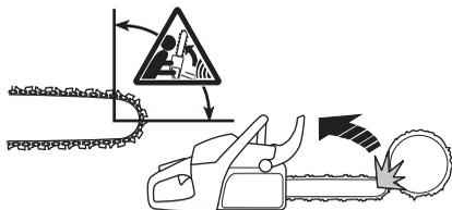
Il taglio con la parte inferiore della lama, cioè dalla parte superiore dell'oggetto verso il basso, si chiama taglio con catena a tirare. La motosega viene tirata verso il tronco e il bordo anteriore del corpo della motosega diventa un appoggio naturale. Questa tecnica assicura il massimo controllo della motosega e della posizione del settore a rischio.
