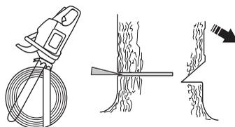
Il taglio di abbattimento deve finire parallelo alla linea del taglio direzionale, con una distanza tra i due di almeno 1/10 del diametro del tronco. La parte di tronco non tagliata è il fulcro.
