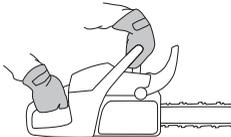
Accelerare al massimo e attivare il freno della catena girando il polso sinistro verso la protezione anticuntraccolpo. Non lasciare l'impugnatura anteriore.
