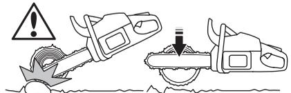
Se è possibile (si può girare il tronco?) terminare a 2/3 dello spessore del tronco.
