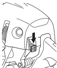
NB! Il contatto di avviamento/arresto torna automaticamente in posizione di marcia. Prevenire l'avviamento involontario staccando sempre il cappuccio dalla candela prima di effettuare operazioni di montaggio, controllo e/o manutenzione.
