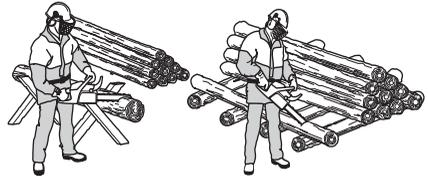
**Il tronco è per terra.** Nessun rischio di bloccaggio della catena o di rottura del tronco. Esiste il rischio che la catena vada a colpire il terreno alla conclusione del taglio.
