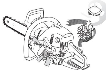
**IMPORTANTE!** Per mantenere sempre un livello ottimale di funzionamento della depurazione centrifuga, il sistema va pulito agli intervalli indicati. Pulire la presa dell'aria sul dispositivo di avviamento, le alette del volano, lo spazio
