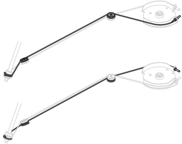
Notez que le câble doit être placé dans la rainure du pignon en plastique avant d'être réacheminé dans le haut de l'arbre. Si la machine a une transmission hydrostatique (M125-97FH), le câble droit doit être acheminé sous le bras du frein de stationnement et le câble gauche doit être acheminé sur le bras du frein de stationnement.
