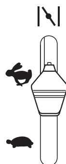
(RU) Разогретый двигатель: переместите регулятор газа на пол-пути в положение полного газа “”.
