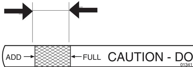
**(RU)** Уровень масла должен находиться между двумя отметками на масляном щупе. Для дозаправки залейте масло SAE 30 до отметки "FULL" (ПОЛНЫЙ). Зимой (при температуре ниже нуля) используйте масло SAE 5W-30.
