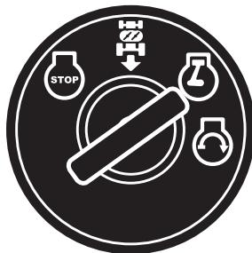
**(RU)** После запуска двигателя оставьте ключ зажигания в положении “ON”. Установите регулятор газа на нужную скорость. Для кошения: полный газ
