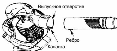
2. Закрепите трубку, повернув болт по часовой стрелке.
