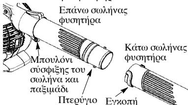
4. Περάστε τον κάτω σωλήνα φυσητήρα στον επάνω σωλήνα φυσητήρα.
