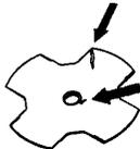
**AVERTISSEMENT:** L'utilisation d'une lame incorrecte ou endommagée peut provoquer des blessures graves ou mortelles. Toujours jeter une lame pliée, faussée, fissurée, cassée ou abîmée de toute autre façon. Ne jamais essayer de redresser une lame faussée pour l'utiliser de nouveau. Utiliser uniquement des lames d'origine du modèle recommandé.
