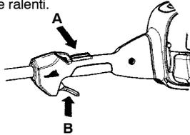
Vérifier d'abord que la commande de l'accélération est bloquée en position de ralenti quand le blocage de l'accélération est en position initiale.
