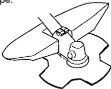
S'assurer que la protection est intacte et qu'elle ne présente pas de fissures. Remplacer la protection si elle a subi des coups ou si elle présente des fissures. Toujours utiliser la protection recommandée prévue pour l'équipement de coupe en question. Voir Caractéristiques techniques.
