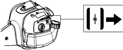
**REMARQUE:** Si le moteur meurt, mettez le levier bleu de l'étrangleur du moteur à la position HALF CHOKE (1/2). Tirer la corde jusqu'à ce que le moteur tourne. Mettez le levier bleu de l'étrangleur du moteur à la position OFF CHOKE (ouvert).
