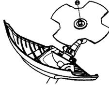
Pose: serrer l'écrou dans le sens contraire de la rotation de l'équipement de coupe.
