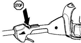
**REMARQUE!** L'interrupteur d'arrêt se remet automatiquement en position de démarrage. Toujours retirer le chapeau de bougie de la bougie lors du montage, contrôle et/ou entretien, afin d'éviter tout démarrage accidentel.
