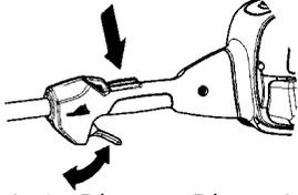
Voir le chapitre Démarrage. Démarrer la machine et donner les pleins gaz. Relâcher l'accélérateur et s'assurer que l'équipement de coupe s'arrête et qu'il reste immobile. Si l'équipement de coupe tourne lorsque l'accélérateur est au régime de ralenti, contrôler le réglage du ralenti du carburateur. Voir le chapitre Entretien.
