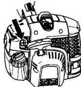
**Étrangleur:** Mettez le levier bleu de l'étrangleur du moteur à la position FULL CHOKE (fermée).
