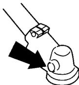
Il lubrificante nell'alloggiamento del riduttore non va normalmente cambiato se non in caso di eventuali riparazioni.
