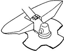
Controllare che la protezione sia integra e priva di incrinature. Sostituire la protezione se è stata sottoposta a urti o se è incrinata. Usare sempre la protezione consigliata per ogni specifico gruppo di taglio. Vedi capitolo Dati tecnici.
