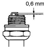
**N.B.!** Usare candele originali o di tipo raccomandato! Altre candele possono danneggiare cilindro e pistone.
