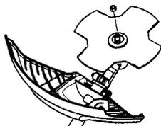
Durante il montaggio, avvitare il dado girando in senso contrario a quello di rotazione del gruppo di taglio. Durante lo smontaggio, svitare il dado nel senso di rotazione del gruppo di taglio. (**NOTA!** La filettatura del dado è sinistrorsa).
