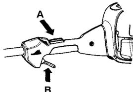
Controllare che l'acceleratore sia bloccato sul minimo quando il fermo è in posizione di riposo.
