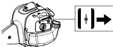
**NOTA!** Se il motore si spegne, riportare la leva della valvola dell'aria di HALF CHOKE ( $\frac{1}{2}$ ) posizione. Tirare la cordicella fino a che il motore non si avvia. Spostare la leva della valvola dell'aria di posizione di OFF CHOKE (aperta).
