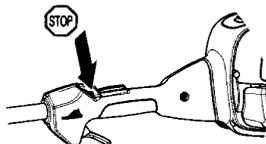
**N.B.!** Il contatto di arresto torna automaticamente in posizione di avviamento. Prevenire l'avviamento involontario staccando sempre il cappuccio dalla candela prima di effettuare operazioni di montaggio, controllo e/o manutenzione.
