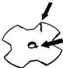
**ADVERTENCIA:** El uso de una cuchilla incorrecta o dañada puede provocar heridas graves o muerte. Cambie siempre la hoja si la misma está doblada, torcida, agrietada, quebrada o dañada de algún otro modo. No trate nunca de enderezar una hoja torcida para volver a utilizarla. Utilice únicamente cuchillas originales del tipo recomendado.
