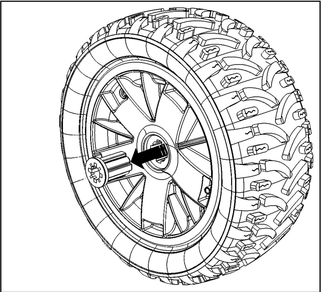
Mit einem Hammer und einem Dorn mit 19 mm Ø die alte Buchse aus dem Radinneren herausschlagen.
