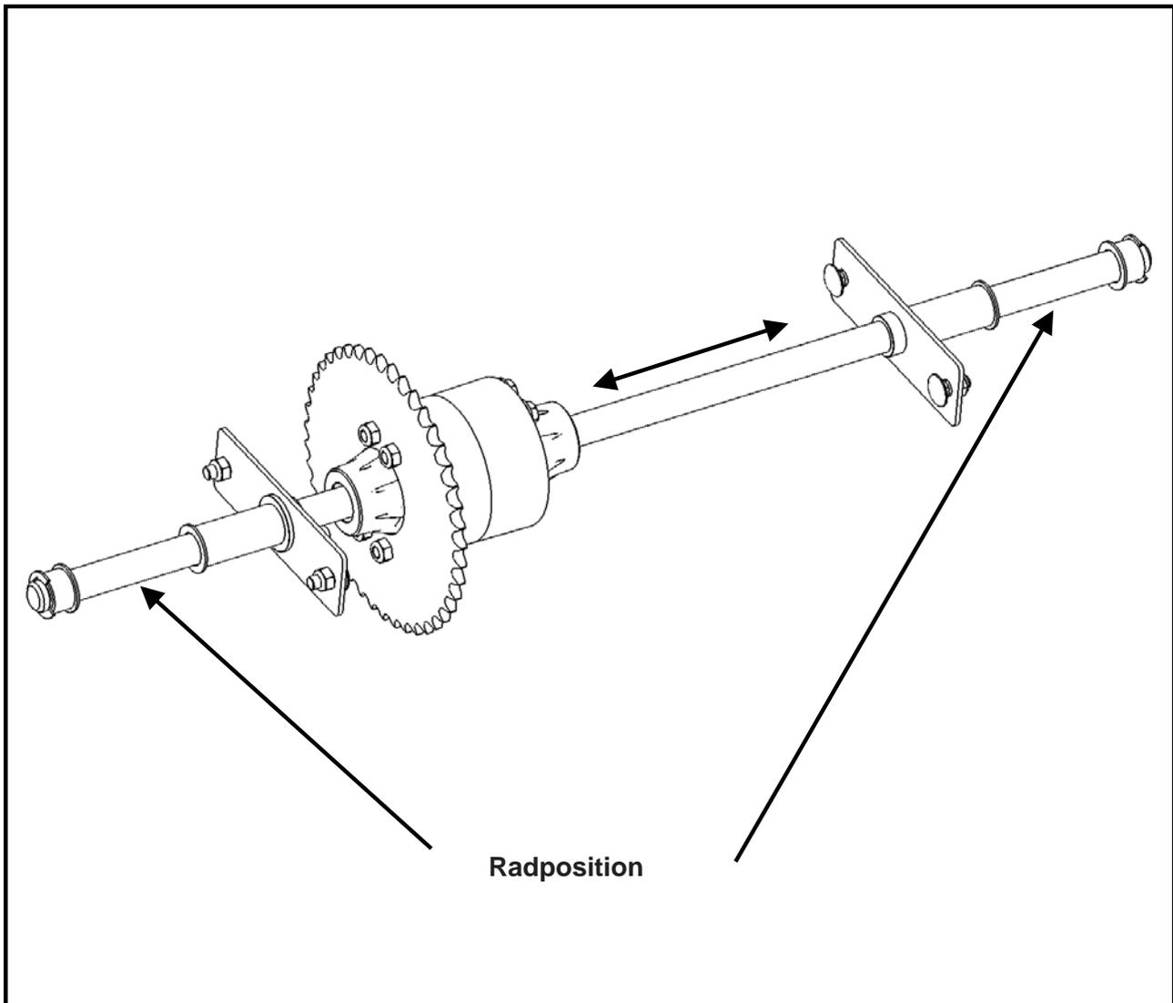
Die Vorderachse ist ohne Räder leicht seitlich verschiebbar und wird nur mit den Rädern in ihrer Position fixiert. Daher eines der Räder wieder montieren. Wenn die Welle nicht genug vorsteht, um E-Clip, Hülse und Scheibe zu montieren, muss sie möglicherweise von der gegenüberliegenden Seite etwas nach innen gedrückt werden.
