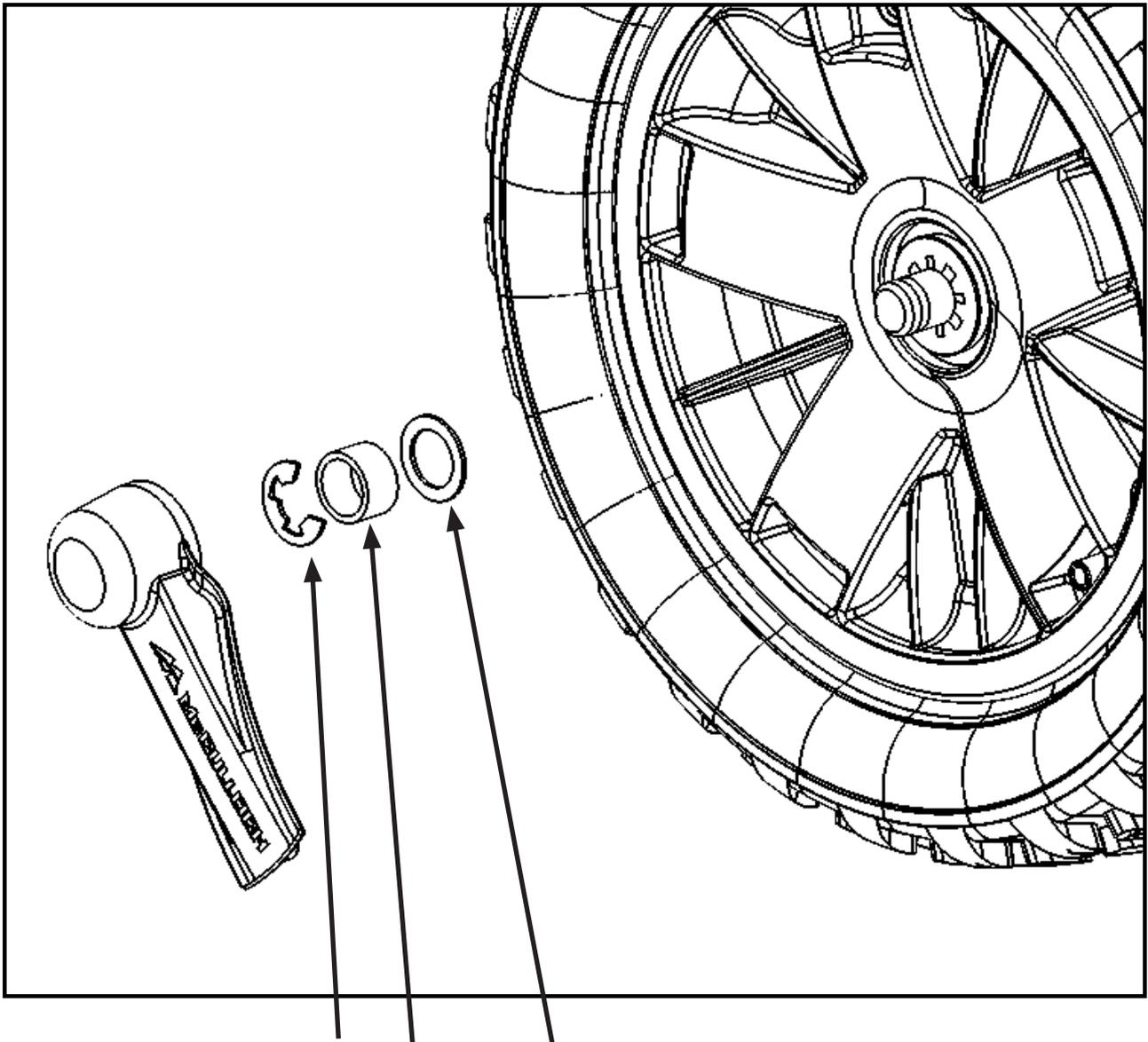
Vor dem Entfernen von E-Clip, Hülse und Scheibe die Reihenfolge notieren.
