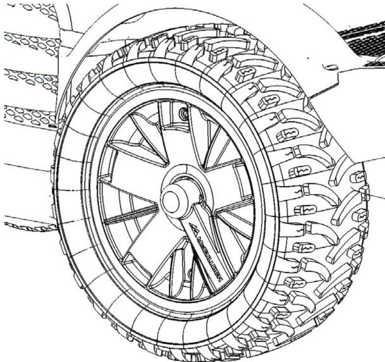
Die beiden Vorderräder mit einem Wagenheber oder Flaschenzug vom Boden anheben. Dazu versuchen, die Hebepunkte am Rahmen ausfindig zu machen, und darauf achten, dass die Riemen oder andere bewegliche Teile unter dem Rahmen nicht beschädigt werden.
