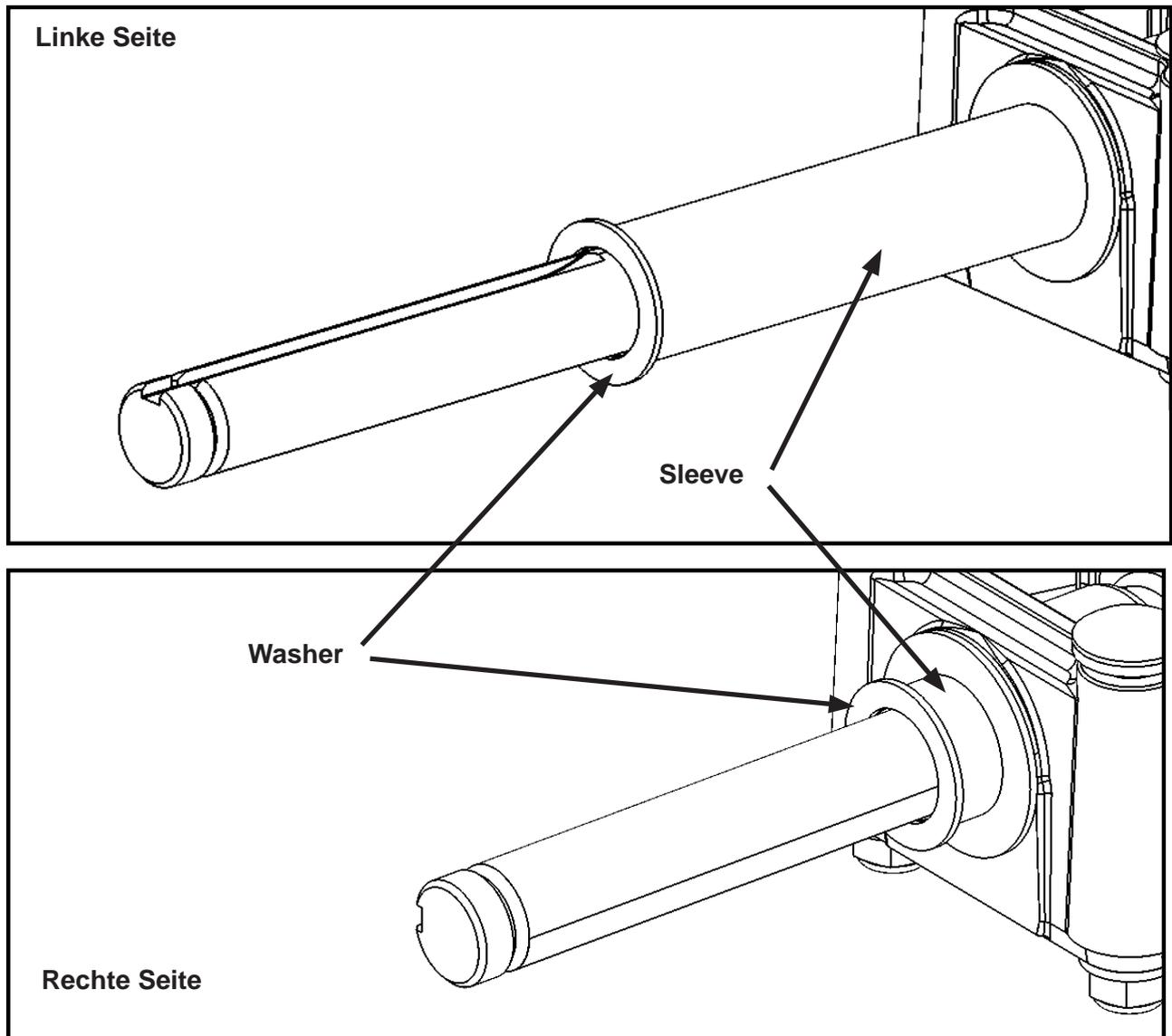
Prüfen, dass eine Scheibe und eine Hülse an der Welle angebracht bleiben - gelegentlich bleibt die Scheibe im Fett an der Innenseite der Felge stecken.
