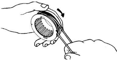
7. Avvolgere i due capi del filo uniformemente e saldamente in senso orario.
