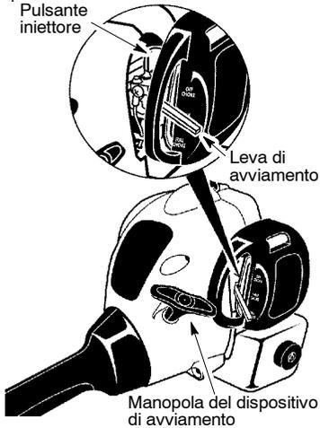
5. Tirare la manopola del dispositivo di avviamento energicamente fino a che il motore comincia a girare.
