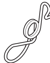
Пружинная защелка травосборника Koguļa vedrulukusti Pakuotuvo spyruoklinis fiksatorius Atsperes fiksators Заключваща пружина на сеносьбирача Închizătoarea cu arc pentru sac
