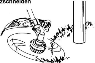
**RASENMÄHEN** - Der Grastrimmer ist ideal zum Rasenmähen in Bereichen geeignet, die der normale Rasenmäher nicht erreichen kann. Zum Rasenmähen halten Sie den Faden parallel zum Boden. Vermeiden Sie es, den Kopf in den Boden zu drücken, da dabei Boden und Werkzeug beschädigt werden können.
