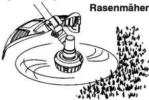
**FEGEN** - Die fächerförmige Aktion des rotierenden Fadens kann eingesetzt werden, um loses Schnittgut aus dem Bereich wegzublasen. Halten Sie den Faden parallel zum und oberhalb des Bodens und führen Sie mit dem Werkzeug eine fegende Bewegung von einer Seite zur anderen durch.
