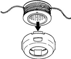
10. Ziehen Sie die Fadenenden durch die Ausgangsbohrungen auf den Seiten der Schutzhaube.
