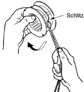
7. Halten Sie Ihren Finger zwischen den beiden Fäden und wickeln Sie die Fäden gleichmäßig und fest nach rechts um die Spule.
