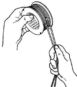
8. Setzen Sie die Fäden in die Führungsschlitze ein.
