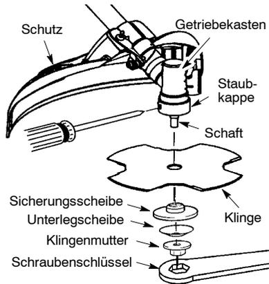
**HINWEIS:** Achten Sie darauf, dass alle Teile wie illustriert befestigt wurden und dass sich die Klinge zwischen der Staubkappe und der Sicherungsscheibe befindet. Zwischen der Klinge und der Staubkappe oder Sicherungsscheibe sollte kein Zwischenraum vorhanden sein.
