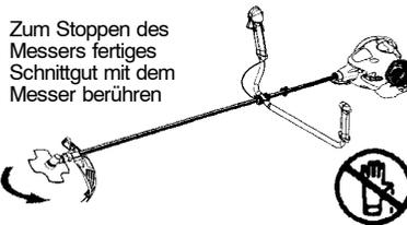
Zum Stoppen des Messers fertiges Schnittgut mit dem Messer berühren
