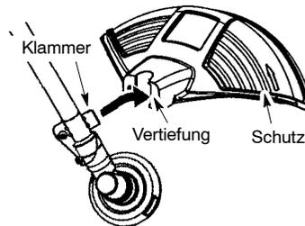
2. Drehen Sie den Schutz hin und her, bis sich die Löcher auf dem Schutz mit denen in der Halterung decken.
