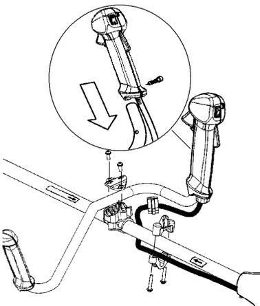
7. Der Handgriffhalter muss zwischen den Pfeilmarkierungen am Führungsrohr montiert sein.
