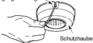
11. Bauen Sie Trommel und Schutzhaube wieder in den Trimmerkopf ein. Drücken Sie auf die Schutzhaube, bis sie einrastet.
