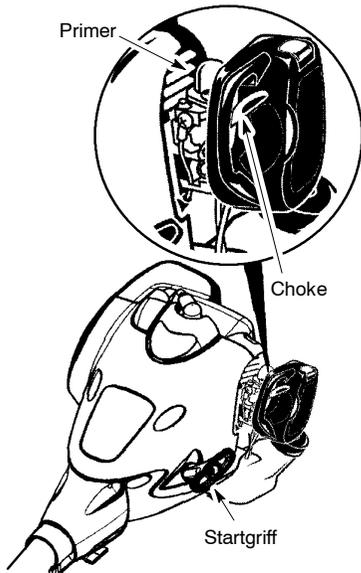
5. Drücken Sie zum Start zunächst die Gashebelsperre, danach den Gashebel und anschließend den Startgasknopf. Lassen Sie dann die Gashebelsperre, den Gashebel und zum Schluss den Startgasknopf los. Die Vergaserfunktion ist jetzt aktiviert.
