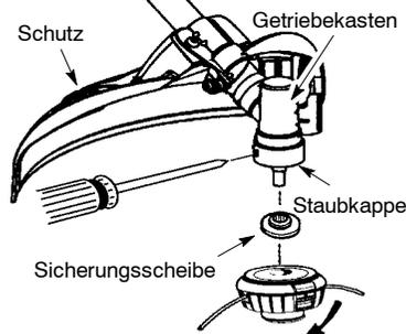
**HINWEIS:** Vergewissern Sie sich, dass alle Bauteile wie im Bild gezeigt montiert sind, bevor Sie mit dem Fadenkopf arbeiten.
