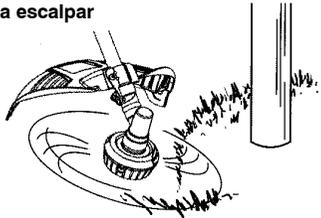
**PARA CORTAR CÉSPED** - Este parato es ideal para cortar césped en lugares donde las cortadoras convencionales no llegan. En posición de cortar césped, mantenga la línea paralela al suelo. Evite presionar el cabezal contra el suelo, ya que de hacerlo podría escalar la vegetación y dañar el aparato.
