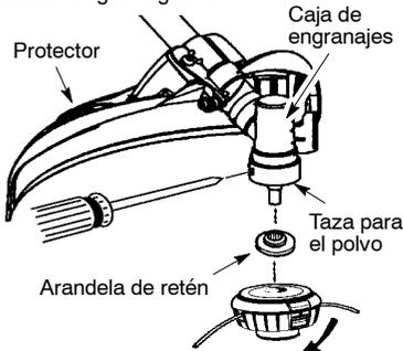
**AVISO:** Antes de instalar el cabezal de corte, asegúrese de que todos los componentes estén instalados correctamente según aparecen en la ilustración.
