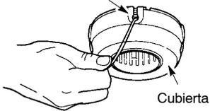
11. Reinstale la bobina y la cubierta en el cabezal de corte. Empuje hasta que la cubierta encaje en su sitio.
