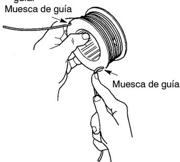
9. Coloque la bobina en la cubierta.
