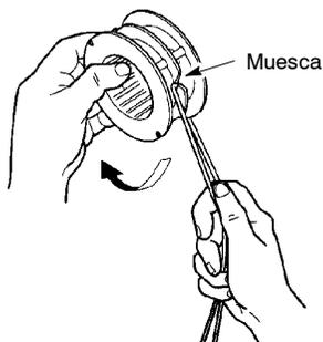
7. Coloque el dedo entre las líneas y enróllelas de manera uniforme y con firmeza alrededor de la bobina, en el sentido de las agujas del reloj.
