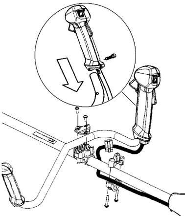
7. La sujeción del mango debe montarse encima de la flecha en el tubo.
