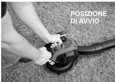
**AVVERTENZA:** Quando si avvia il motore, tenere l'unità come mostrato nell'illustrazione. Quando si avvia il motore o quando il motore è acceso, collocare l'unità solo su una superficie pulita e rigida. I detriti come ghiaia, sabbia, polvere, erba ecc. possono essere catturati dalla presa d'aria e scagliati attraverso l'apertura di scarico provocando danni all'unità e alle cose o provocando lesioni gravi ai presenti o all'operatore.
