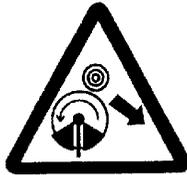
**ACHTUNG:** Der Fadenkopf/Messer kann Objekte mit Druck aufwirbeln. Sie und andere Personen können dadurch erblinden oder verletzt werden. Tragen Sie immer eine Schutzbrille und Schutzstiefel.
