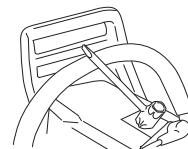
Σημίωση! Χρησιμοποιείτε πάντοτε τον τύπο μπουζιού που συστήνεται! Λάθος τύπος μπορεί να προκαλέσει ζημιά στο έμβολο/κύλινδρο. Ελέγχετε αν το μπουζί είναι εφοδιασμένο με συμπιεστή.
