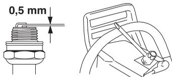
Bemærk! Brug altid anbefalet tændrørstype! Forkert tændrør kan ødelægge stempel/cylinder. Kontrollér, at tændrøret har såkaldt radiostøjdæmpning.
