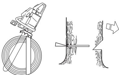
Hovedskåret skal avsluttes parallelt med styreskårlinjen slik at avstanden mellom dem er minst 1/10 av stammens diameter. Den delen av stammen som ikke er gjennomsagt, kalles brytekant.
