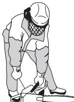
Trykk inn choken umiddelbart når motoren tenner og gjør flere startforsøk til motoren starter. Når motoren starter gir du raskt full gass, og startgassen koples ut automatisk.
