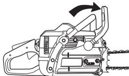
**Tenning; choke:** Still chokehendelen i chokestilling. Stoppbryteren skal da stilles automatisk på startposisjon.
