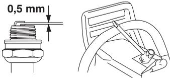
Bemerk! Bruk alltid anbefalt type tennplugg! Feil tennplugg kan ødelegge stempel/sylinder. Påse at tennpluggen har såkalt radiostøyfilter.
