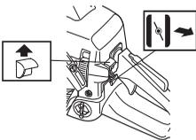
**Startgas:** Kombinerat choke/startgasläge erhålls när reglaget ställs i chokeläge.
