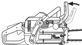
Skruva bort svärdsnuttrarna och tag bort kopplingskåpan (kedjebromsen). Avlägsna transportskyddet (A).
