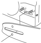
Spänn kedjan genom att med hjälp av kombinyckeln skruva kedjespännarskraven medurs. Kedjan skall sträckas tills den inte hänger slak på svärdets undersida.
