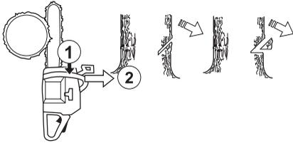
Retningsnitdybden skal være 1/4 af stammens diameter, og vinklen mellem over- og undersnit skal være mindst 45°.
