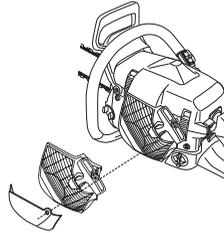
Disse reduserer kjøleluften og hindrer at større mengder snø suges inn i forgasserrommet.
