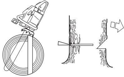
Fældesnittet skal afsluttes parallelt med retningsnitlinjen, så afstanden mellem de to er mindst 1/10 af stammens diameter. Den ikke gennemsavede del af stammen kaldes brudpunktet.
