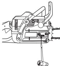
Kedjan är korrekt spänd när den inte hänger slak på svärdets undersida och fortfarande kan dras runt lätt för hand. Drag fast svärdsnuttrarna med kombinyckeln samtidigt som svärdsspetsen hålls upp.
