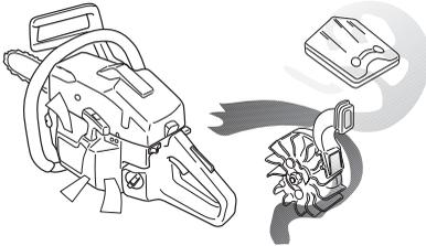
**VIGTIG!** For å opprettholde sentrifugalrensingens funksjon, må den rengjøres og vedlikeholdes kontinuerlig. Rengjør luftinntaket til startmotoren, vifteskivene på svinghjulet, rommet rundt svinghjulet, inntaksrøret og forgasserrommet.
