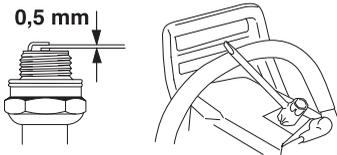
Notera! Använd alltid rekommenderad tändstiftstyp! Felaktigt tändstift kan förstöra kol/cylinder. Se till att tändstiftet har s.k. radioavstörning.
