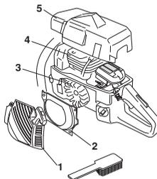
Rens kølesystemet med en børste en gang om ugen, under støvfyldte forhold oftere. Et snavset eller tilstoppet kølesystem medfører overopvarmning af maskinen med skader på cylinderen og stemplet til følge.
