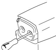
Visse lyddæmpere er udstyret med et specielt gnistfangernet. Hvis din maskine er udstyret med en sådan lyddæmper, bør nettet rengøres en gang om ugen. Dette gøres bedst med en stålbørste. Et tilstoppet net medfører, at motoren kører varm med alvorlig motorskade til følge.
