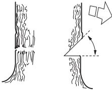
Ylä- ja alasahauksen kohtaamispaikkaa kutsutaan kaatoloviliinjaksi. Kaatoloviliinjan on oltava tarkasti vaakasuorassa ja muodostettava samalla suoralla kulmalla (90°) valittuun kaatosuuntaan nähden.
