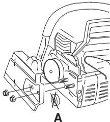
Montér sværdet over sværdboltene. Placér sværdet i dets bagerste stilling. Placér kæden over kædedrivhjulet og i sværdsporet. Begynd på sværdets overside.
