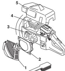
Puhdista jäähdytysjärjestelmä harjalla kerran viikossa, vaikeammissa käyttöolosuhteissa useammin. Likainen tai tukkeentunut jäähdytysjärjestelmä johtaa koneen ylikuumentumiseen, josta on seurauksena sylinterin ja männän vaurioituminen.
