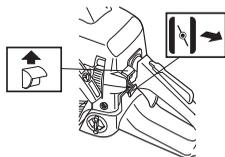
**Käynnistyskaasu:** Yhdistetty rikastus/käynnistyskaasuasento saadaan siirtämällä säädin rikastusasentoon.
