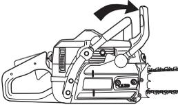
**Tändning; choke:** Ställ chokereglaget i chokeläge. Stoppkontakten skall då automatiskt ställas i startposition.
