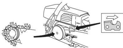
Tarkasta, että hammaslenkkien teräsarmat ovat eteenpäin terälevyn yläpuolella.
