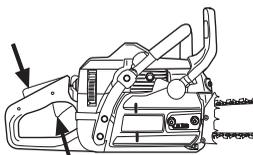
Notera! Återställ kedjebromsen genom att föra kastskyddet mot handtagsbygeln. Motorsågen är härmed klar för användning.
