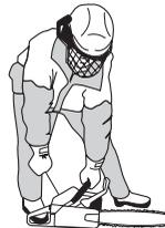
Tryck in chokereglaget omedelbart när motorn tänds och gör förnyade startförsök tills motorn startar. När motorn startar, ge snabb fullgas och startgasen kopplas automatiskt ur.
