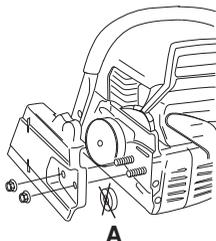
Asenna terälevy teräpulteihin. Aseta terälevy takimmaiseen asentoonsa. Aseta ketju ketjupyörälle ja terälevyn ohjausraan. Aloita terälevyn yläpuolelta.
