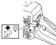
Motorn stannas genom att skjuta stoppkontakten till stoppläge.
