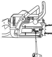
Ketjun kireys on oikea, kun se ei roiku löysällä terälevyn alapuolella ja liikkuu kevyesti käsin pyöritettäessä. Kiristä terämutterit yhdistelmäavaimella pitäen samalla terälevyn kärkeä ylhäällä.
