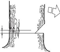
Sätt i barkstödet (om något är påmonterat) bakom brytmånen. Såga med fullgas och för sågkedjan/svärdet sakta in i trädet. Var observant på om trädet rör sig i motsatt riktning till vald fallriktning. Sätt i en fällkil eller ett brytjärn i fällskåret så snart skärdjupet tillåter.
