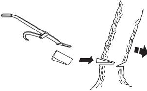
Vi rekommenderar användande av en svärdslängd som överstiger trädets stamdiameter, så att fäll- och riktskår kan utföras med ett s.k. "enkelt sågsnitt". Se anvisningar under rubrik Tekniska data angående vilka svärdslängder som rekommenderas för din motorsågsmodell.
