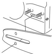
Spænd kæden ved at bruge kombinøglen til at skruer kædestrammerskruen med uret. Kæden skal strammes til, så den ikke hænger slapt ned på sværdets underside.
