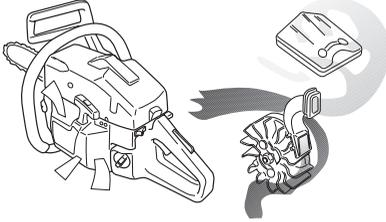
**VIGTIGT!** For at bevare centrifugalrensningens funktion skal man udføre kontinuerlig pleje og vedligeholdelse. Rens startaggregatets luftindtag, svinghjulets ventilatorflanger, området omkring svinghjulet, indsuigningsrøret og karburatorrummet.
