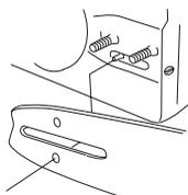
Kiristä ketju kiertämällä ketjun kiristysruuvia yhdistelmäavaimella myötäpäivään. Ketjua on kiristettävä sen verran, ettei se roiku löysällä terälevyn alapuolella.
