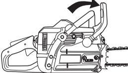
**Tænding; choker:** Sæt chokeren i chokerstilling. Stopkontakten indstilles herefter automatisk til startposition.
