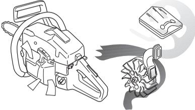
**TÄRKEÄÄ!** Keskipakoispuhdistuksen tehon säilyttämiseksi on huolehdittava säännöllisestä huollosta. Puhdista käynnistimen ilmanottoaukot, vauhtipyörän tuuletinsiivet, vauhtipyörän ympäristö, imuputki ja kaasutintila.
