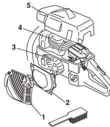
Rengjør kjølesystemet med en børste en gang i uken, ved vanskelige forhold oftere. Et tilsusset eller tett kjølesystem fører til at maskinen overopphetes, noe som forårsaker skader på sylinder og stempel.
