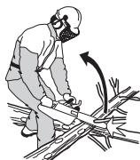
Saetav puu peab olema kontrolli all. Kui te saete väikseid ja kergeid puutükke, võivad need jäädva saeketti kinni ja paiskuda teie vastu. See võib ka mitte ohtlikke kahjustusi tekitada, aga siiski ehmatada ja te võõte kaotada kontrolli sae üle. Ärge saagige virna või oksi hunnikus, võtke nad eraldi ette. Saagige ainult ühte tüve või oksa korraga. Võtke lahtisaetud tükid ära ja kontrollige, et teie töökohatoleks kogu aeg korras ja jalgealune kindel.
