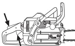
Observe! Rearme o travão da corrente levando a protecção contra o retrocesso em direcção ao arco dos punhos. A moto-serra está agora pronta a ser usada.
