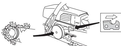
Verifique se o fio dos elos de corte está voltado para a frente, na parte superior da lâmina.
