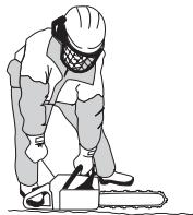
Segure a moto-serra numa posição firme, com os polegares e dedos à volta do punho.
