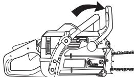
**Encendido; estrangulador:** Ponga el estrangulador en la posición de estrangulamiento. Entonces, el botón de parada se desplazará automáticamente hacia la posición de arranque.
