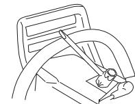
Aclaración! ¡Utilice siempre el tipo de bujía recomendado! Una bujía incorrecta puede arruinar el pistón y el cilindro. Asegúrese de que la bujía tenga supresión de perturbaciones radioeléctricas.
