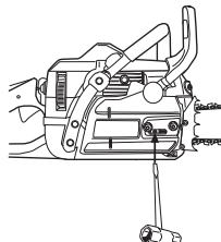
La cadena está correctamente tensada cuando no cuelga en la parte inferior de la espada y puede girarse fácilmente con la mano. Apriete las tuercas de la espada con la llave combinada, sujetando al mismo tiempo la punta de la espada.
