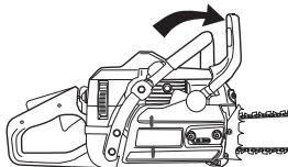
**Ignição; estrangulador:** Ponha o estrangulador na posição de estrangulador. O contacto de paragem irá automaticamente para a posição de arranque.
