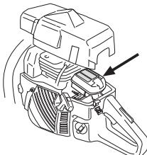
Uma limpeza mais completa obtém-se ao lavar o filtro com água e sabão.
