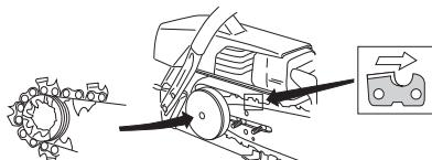
Compruebe que los filos de los eslabones de corte estén orientados hacia delante en la parte superior de la espada.
