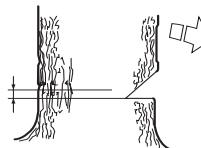
Coloque el apoyo de corteza (si ha sido montado) detrás de la faja de desgaje. Corte con aceleración máxima introduciendo lentamente la cadena/espada en el tronco. Preste atención a si el árbol se mueve en dirección opuesta a la elegida para el derribo. Tan pronto lo permita la profundidad de corte, ponga una cuña de derribo o una barra desgajadora en el corte de derribo.
