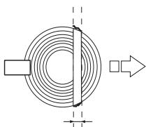
A linha de ruptura funciona como uma dobradiça que comanda a direcção da queda da árvore.
