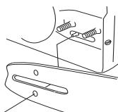
Estique a corrente, apertando com o auxílio da chave universal o parafuso esticador da corrente, no sentido horário. Estique a corrente até que esta deixe de estar frouxa na parte inferior da lâmina.
