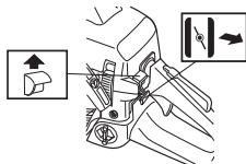
**Aceleración de arranque:** Para la función combinada de estrangulamiento/acceleración de arranque ponga el estrangulador en la posición de estrangulamiento.
