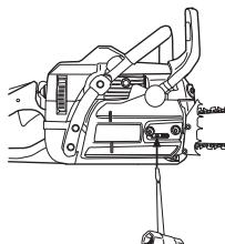
A corrente está correctamente esticada quando não mais estiver frouxa na parte inferior da lâmina e ainda possa ser girada facilmente com a mão. Aperte bem as porcas da lâmina com a chave universal ao mesmo tempo que segura a extremidade da lâmina.
