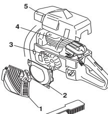
Limpe o sistema de arrefecimento com uma escova, uma vez por semana, ou com mais frequência, em condições de trabalho difíceis. O sistema de arrefecimento obstruído ou sujo conduz a um sobreaquecimento da máquina, danificando o cilindro e o pistão.
