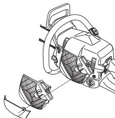
Estas medidas reduzem a entrada de ar frio e impedem a sucção de maiores quantidades de neve para o compartimento do carburador.
