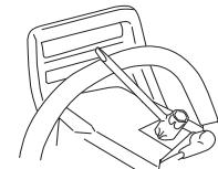
Observe! Use sempre o tipo de vela de ignição recomendado! Uma vela de ignição incorrecta pode danificar o pistão/cilindro. Verifique se a vela de ignição não produz interferências de rádio.
