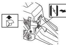
**Aceleração de arranque:** A posição combinada estrangulador/aceleração de arranque obtém-se ao colocar o comando na posição de estrangulador.
