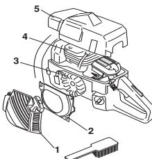
Limpie el sistema refrigerante con un cepillo una vez por semana (en condiciones difíciles, con mayor frecuencia). Un sistema refrigerante sucio u obturado produce sobrecalentamiento de la máquina, con las consiguientes averías del cilindro y el pistón.
