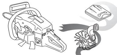
**¡IMPORTANTE!** Para que la depuración centrífuga funcione satisfactoriamente, debe efectuarse un mantenimiento constante del sistema. Limpie la toma de aire del mecanismo de arranque, las palas de ventilador del volante, el espacio alrededor del volante, el tubo de admisión y el compartimiento del carburador.
