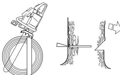
O corte de abate deverá terminar paralelamente à linha de corte direccional de modo que a distância entre ambos
