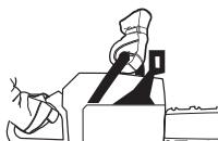
Acelere ao máximo e active o travão de corrente, virando o pulso esquerdo contra a protecção anti-retrocesso. Não solte o punho dianteiro. **A corrente deverá parar imediatamente.**
