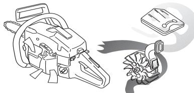
**IMPORTANTE!** Para conservar a função de purificação centrífuga, é necessário prestar assistência e manutenção contínuas. Limpe a entrada de ar do dispositivo de arranque, asas de ventoinha da cambota, compartimento em torno da cambota, tubo de admissão e compartimento do carburador.
