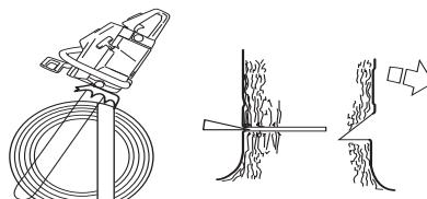
El corte de derribo debe quedar paralelo con la línea de corte de indicación, con una distancia mínima entre ambos de 1/10 del diámetro del tronco. La parte del tronco sin cortar se denomina faja de desgaje.
