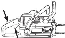
Aclaración! Para poner el freno de cadena en su posición inicial, mueva la protección contra reculadas hacia la empuñadura del mango. Ahora, la motosierra está lista para funcionar.
