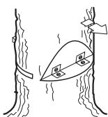
Perde-se todo o controlo sobre a direcção de queda da árvore se a linha de ruptura for demasiado pequena ou muito serrada, ou se o corte direccional e o corte de abate estiverem incorrectamente posicionados.
