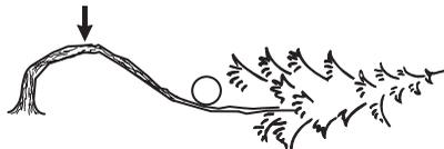
Premyslite si najbezpečnejší spôsob uvoľnenia pnutia a zvážte, či to dokážete bezpečne urobiť. V komplikovaných prípadoch je jedinou bezpečnou metódou odložiť reťazovú pílu a použiť navijak.
