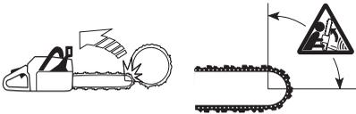
Odbicie powstaje zawsze w płaszczyźnie tnącej prowadnicy. Zazwyczaj pilarka i prowadnica zostają odrzucone do tyłu i do góry, w kierunku operatora. Pilarka może zostać odrzucona w
