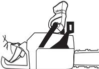
Adjon teljes gázt, és helyezze üzembe a láncfékelt bal csuklója előrehajlításával, anélkül, hogy a fogantyút elengedné. **A láncnak azonnal meg kell állnia.**
