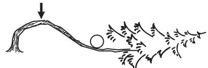
Określ najbardziej bezpieczny sposób zwolnienia naprężenia i ocen czy jesteś w stanie to wykonać. W bardzo skomplikowanych sytuacjach najbezpieczniej jest zrezygnować z pracy pilarką i użyć wciągarki.
