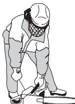
Jakmile motor naskočí, zasaňte páčku sytiče a tahejte, dokud motor nenastartuje. Po nastartování motoru rychle přidejte plyn až do plných otáček; pojistka páčky plynu se automaticky vypne.
