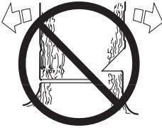
Amikor a döntőhajak és a döntővágás elkészült, a fának saját súlyától, vagy pedig a döntőék vagy a döntőemelő segítségével el kell dőlnie.
