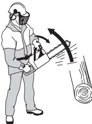
При по-слаб тласък или ако рисковият сектор на тласъка на шината се намира по-близо до оператора, верижната спирачка се включва ръчно с лявата ръка.
