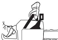
Daj puni gas i aktiviraj kočnicu lanca tako da okreneš lijevi ručni zglob prema štitniku trzaja. Ne puštaj prednji rukohvat. **Lanac se odmah zaustavlja.**
