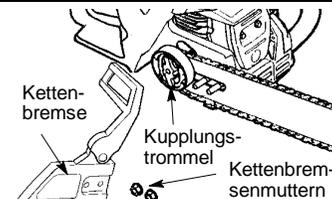
3. Die Kettenspannung wird über eine Justierschraube und einen Mitnehmerzapfen reguliert. Bei der Montage des Kettenschwerts muß der Mitnehmerzapfen der Justierschraube in das Loch im Kettenschwert greifen. Der Mitnehmerzapfen wird durch Drehen an der Justierschraube hin- und herbewegt. Stellen Sie vor Montage des Schwerts sicher, daß Sie die Position der Justierschraube kennen. Siehe Abbildung unten.
