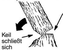
**HINWEIS:** Bevor Sie den Fallschnitt abschließen, weiten Sie den Schnitt falls notwendig mit Hilfe von Keilen, um die Fallrichtung zu kontrollieren. Verwenden Sie ausschließlich Holz- oder Plastikkeile. Stahl- oder Eisenkeile können Rückschlag und Schäden am Gerät verursachen.
