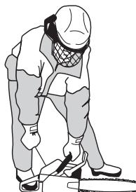
Zatlačte ovládanie sýtiča hned', ako motor odpáli a opakujte, pokým motor nenaštratuje. Keď motor naštartuje, rýchlo pridajte na plný plyn a štartovací plyn sa automaticky uvoľní.
