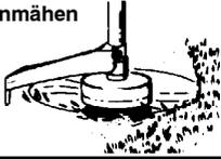
**FEGEN** – Die fächerförmige Aktion des rotierenden Fadens kann eingesetzt werden, um loses Schnittgut aus dem Bereich wegzublasen. Halten Sie den Faden parallel zum und oberhalb des Bodens und führen Sie mit dem Werkzeug eine fegende Bewegung von einer Seite zur anderen durch.
