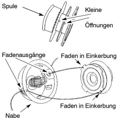
5. Wickeln Sie den Trimmfaden gleichmäßig fest um die Spule. Beachten Sie dabei die Richtungspfeile auf der Spule.
