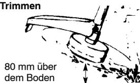
KURZSCHNEIDEN - Dabei wird unerwünschte Vegetation bis auf den Boden entfernt. Halten Sie den Boden des Schneidkopfes etwa 80 mm in einem Winkel über den Boden. Lassen Sie die Fadenspitze um Bäume, Pfosten, Monumente usw. auf den Boden aufschlagen. Diese Technik erhöht die Fadenabnutzung.
