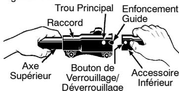
**⚠ AVERTISSEMENT:** Assurez-vous que le bouton de verrouillage/déverrouillage soit bien verrouillé dans le trou principal et que le bouton soit bien en place avant de faire fonctionner votre appareil. Tous les accessoires sont conçus pour être utilisés dans le trou principal à moins que le manuel d'instruction de l'accessoire indique le contraire. Utiliser le mauvais trou peut amener des blessures graves ou endommager votre appareil.
