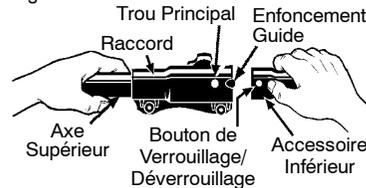
**⚠ AVERTISSEMENT:** Assurez-vous que le bouton de verrouillage/déverrouillage soit bien verrouillé dans le trou principal et que le bouton soit bien en place avant de faire fonctionner votre appareil. Tous les accessoires sont conçus pour être utilisés dans le trou principal à moins que le manuel d'instruction
