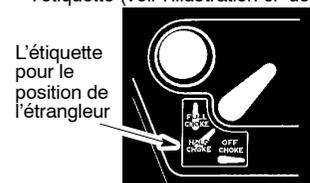
8. Tirez rapidement sur le corde de mise en marche jusqu'à ce que le moteur se mette en marche, mais pas plus de 6 fois. Si le moteur ne part pas après six coups de démarreur (en position «HALF CHOKE»), mettez le levier de l'étrangleur en position «FULL CHOKE» et peser la poire d'amorçage 6 fois; serrez et maintenez serré la gâchette d'accélérateur et tirez sur le corde de mise en marche 2 fois de plus.
