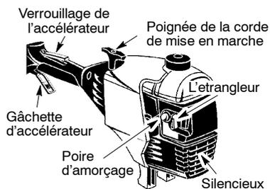
**REMARQUE:** Le verrouillage de l'accélérateur doit être enclenché pour permettre l'utilisation de la gâchette d'accélérateur. Le verrouillage s'enclenche avec la paume de la main quand on tient la poignée de l'accélérateur.
