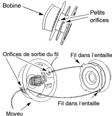
5. Enroulez le fil de façon régulière et serrée sur la bobine. Enroulez-le dans le sens des flèches situées sur la bobine.
