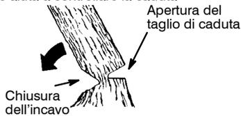
**NOTA:** Prima di completare il taglio di caduta, usare dei cunei per aprire il taglio quando necessario per controllare la direzione di caduta. Usare cunei in legno o plastica, mai in acciaio o ferro, per evitare rinculo e danni della catena.
