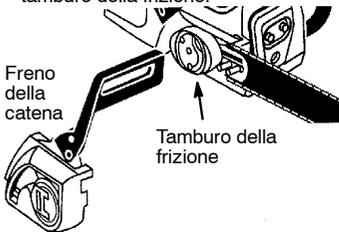
7. Rimuovere con cautela la nuova catena dall'imballaggio. Preparare la catena controllando la direzione appropriata. Senza seguire l'illustrazione, è facile porre la catena sulla sega nella direzione sbagliata. Servirsi dell'illustrazione della catena per determinare la direzione appropriata.
