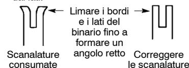
Sostituire la barra di guida quando la scanalatura è consumata, la barra di guida è piegata o incrinata o quando si verifica un eccesso di riscaldamento o di bavatura dei binari. Se è necessario eseguire la sostituzione, usare solo la barra indicata per la sega nell'elenco delle parti di ricambio.
