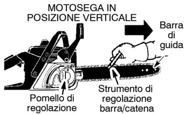
4. Sollevare la maniglia del pomello di regolazione e girarlo in senso antiorario di 1 giro per allentare la barra. La catena viene serrata automaticamente.
