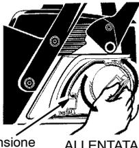
4. Allineare le frecce premendo la leva di messa in tensione (vedere l'illustrazione). Rimuovere il freno della catena dalla sega.
