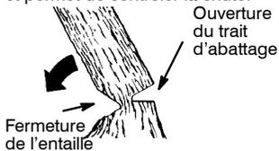
**REMARQUE:** Avant de terminer le trait d'abattage, utilisez des coins pour ouvrir la coupe quand il sera nécessaire de contrôler la direction de la chute. Utilisez des coins en bois ou en plastique, mais jamais des coins en acier ou en fer qui risqueraient d'entraîner un recul ou d'endommager la chaîne.
