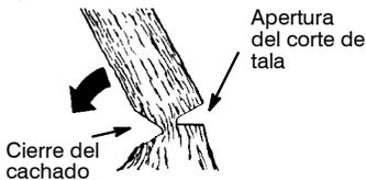
**NOTA:** Antes de completar el corte de talado, utilice cuñas para abrir el corte cuando sea necesario controlar la dirección de caída. Utilice cuñas de madera o de plástico, pero nunca de acero o hierro, que podrían causar rebotes y daños en la cadena.
