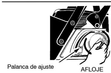
5. Mientras levanta la punta de la barra guía, apriete la perilla de ajuste de la cadena dando vuelta a la derecha hasta que la barra este segura. **Apriete firmemente a mano; ¡no utilice herramientas para apretar!**
