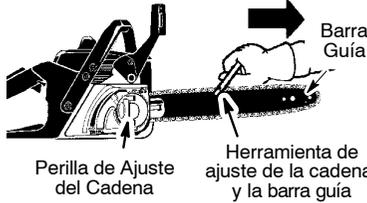
4. Levante la manija de la perilla de ajuste dando vuelta a la izquierda (1) vuelta para aflojar la barra guía. El cadena se apretará automáticamente.
