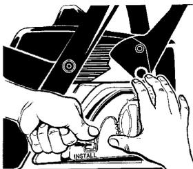
PALANCA DE AJUSTE EN LA POSICION "INSTALL"
