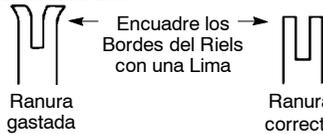
Cambie la barra guía si la ranura está gastada, si la barra guía está torcida o resquebrajada o si hay calentamiento excesivo o formación de protuberancias en los rieles. Si es necesario cambiar la barra guía, use exclusivamente la barra guía especificada para su sierra en la lista de repuestos.
