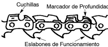
8. Coloque la cadena por encima y detrás del embrague, poner las eslabones de funcionamiento en el cilindro del embrague.
