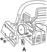
바를 바 볼트 위에 장착합니다. 바를 가장 뒤 위치에 설치합니다. 체인을 구동 스프로켓 위에 놓고 바의 홈에 위치시킵니다. 바의 위 가장자리에서 시작합니다.
