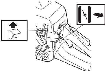
장비에 감압 밸브(A)가 장착된 경우:밸브를 눌러 실린더 내의 압력을 줄이고 시동을 쉽게 만듭니다. 장비를 시동할 때는 항상 감압 밸브를 사용해야 합니다. 일단 장비가 시동되면 밸브는 자동으로 원래 설정으로 돌아갑니다.
