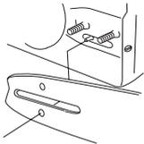
콤비네이션 스패너를 사용하여 체인 장력 조절 나사를 시계 방향으로 돌려서 체인을 팽팽하게 합니다. 체인은 바의 아래쪽으로 처지지 않을 때까지 팽팽하게 당겨야 합니다.
