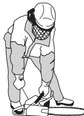
엔진이 발화되면 즉시 초크 제어장치를 밀어 넣고 엔진이 시동될 때까지 계속 당기십시오. 엔진이 시동되면 즉시 스로틀을 완전히 여십시오. 스로틀 롤은 자동으로 해제될 것입니다.
