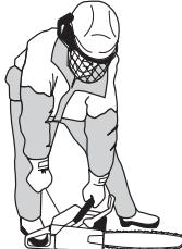
Pošto je kočnica lanca i dalje aktivirana mora se ubrzo broj obrta motora spustiti na prazan hod, što se postiže na taj način da se iskopča zapreka gasa. Sa ovim izbjegavate nepotrebno habanje kvačila, bubnja kvačila kao i kaiša za kočenje.
