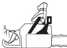
Dodajte puni gas i aktivirajte kočnicu za lanac tako da nagnete zglob na ruci prema naprijed prema prednjem štitu za ruku. Nemojte ispuštiti prednju ručku. **Lanac bi se trebao odmah zaustaviti.**
