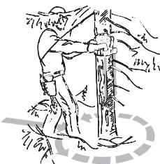
Uklonite bilje koje se nalazi ispod debla i provjerite ima li kamenja, grana, rupa itd koji bi Vam smetali. Svrha toga je da kad drvo počne padati, Vi možete lako odstupiti. Vaš put odstupanja trebao bi se nalaziti otprilike 135° iza planiranog pada drvet
