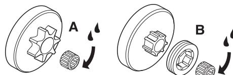
Obje verzije imaju ugrađeno ležište za iglu na pogonskoj osovini koje treba redovno podmazivati (jednom tjedno). PAŽNJA! Koristite samo visokokvalitetno mazivo za ležišta ili motorno ulje.
