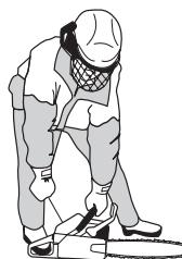
Тъй като верижната спирачка продължава да е задействана, трябва оборотите на двигателя да се приведат на празен ход, което се постига, като бързо се изключи фиксатора на дроселната клапа. Така избягвате излишно износване на съединителя, барабанът на съединителя и спирачната лента.
