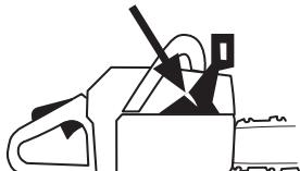
Движете аварийния лост напред и назад, за да проверите дали той се движи свободно и е надеждно закрепен към капака на съединителя.
