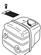
Ποτέ μη χρησιμοποιείτε σιγαστήρα χωρίς ή με ελαττωματικό δικτυωτό φίλτρο σπινθήρων.
