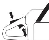
• Βάλτε μπρος το πριόνι και δώστε φουλ γκάζι. Αφήστε το γκάζι και ελέγχετε ότι η αλυσίδα σταματάει και εξακολουθεί να είναι ακίνητη. Αν η αλυσίδα περιστρέφεται με το γκάζι σε θέση ρελαντί πρέπει να ελέγχετε τη ρύθμιση του ρελαντί στο καρμπιρατέρ.
