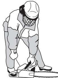
Afferrare saldamente l'impugnatura anteriore con la sinistra. Porre il piede destro sulla parte inferiore della maniglia posteriore e premere la motosega contro il terreno. Tirare lentamente la cordicella con la destra, fino a quando fa resistenza (entra in presa il dispositivo di avviamento) e tirare quindi con strappi decisi e veloci. **Non avvolgere mai la cordicella di avviamento intorno alla mano.**
