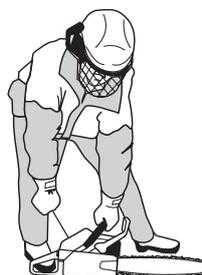
Agarre el mango delantero con la mano izquierda. Pise la parte inferior del mango trasero con el pie derecho y presione la motosierra contra el suelo. Agarre la empuñadura de arranque con la mano derecha y tire lentamente del cordón hasta que advierta una resistencia (agarran los ganchos de arranque). Luego, dé tirones rápidos y fuertes. **Nunca enrosque el cordón de arranque alrededor de la mano.**
