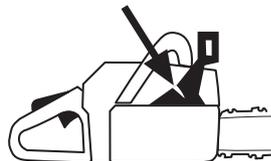
Mova a protecção anti-retrocesso para a frente e para trás, controlando assim se esta funciona a contento e também se está solidamente fixa à sua articulação na cobertura de acoplamento.
