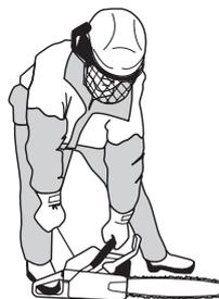
Segure no punho dianteiro com a mão esquerda. Ponha o pé direito na parte inferior do punho traseiro e pressione a moto-serra contra o solo. Agarre na pega do arranque e puxe devagar a corda de arranque com a mão direita até encontrar resistência (os prendedores do arranque actuam) e a partir de então dê puxões rápidos e fortes. **Nunca enrole a corda de arranque na mão.**
