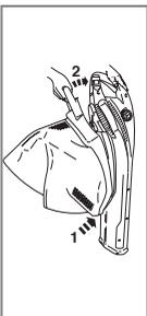
**VOR INSTALLIERUNG** des vollständig zusammengesetzten Auffangsacks am Laubsauger und **VOR ENTFERNUNG** des vollständig zusammengesetzten Auffangsacks muß der Laubsauger ausgeschaltet und von der Netzstromversorgung getrennt werden. **DEN LAUBSAUGER ERST DANN AN DIE NETZSTROMVERSORGUNG ANSCHLIESSEN, WENN DER VOLLSTÄNDIG ZUSAMMENGESetzte AUFFANGSACK KORREKT ANGEBRACHT IST.**
