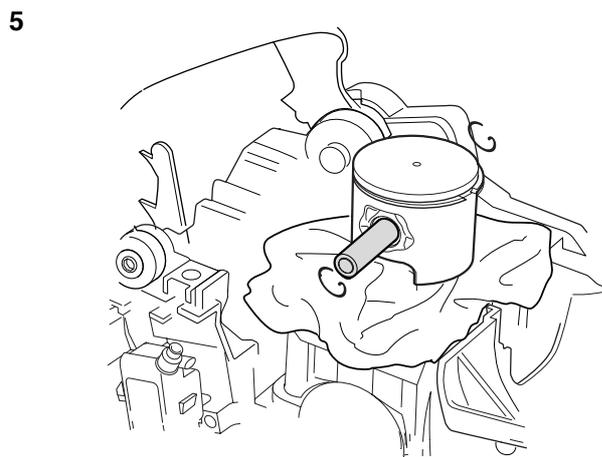
Togliere gli anelli di bloccaggio del bullone del pistone ed estrarre il bullone. Smontare poi il pistone.
