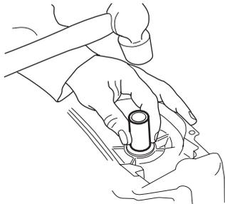
Per montare l'anello di tenuta usare la boccola inclusa nel 502 50 30-16.
